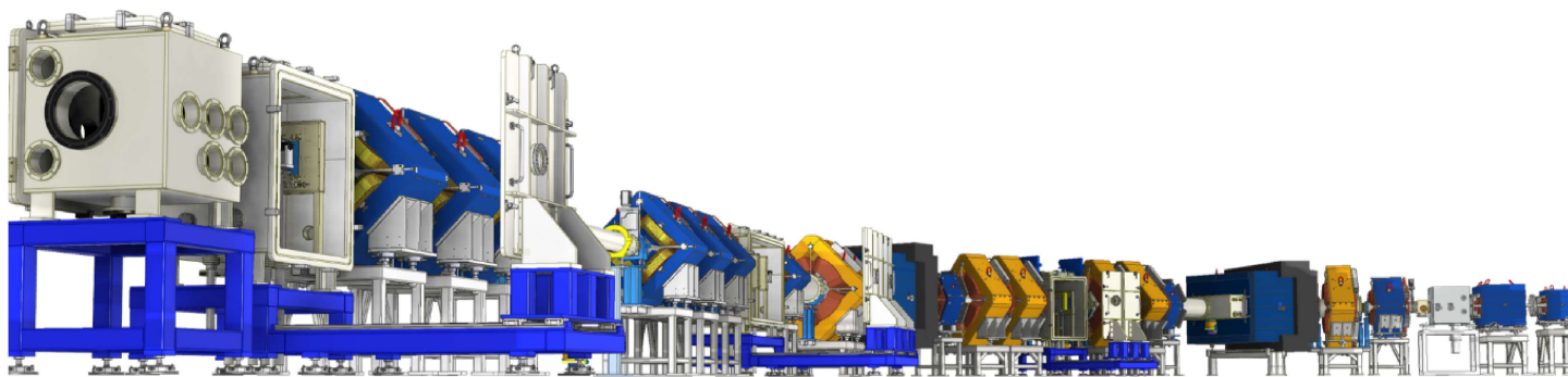
그림7 라온의 핵심 실험장치 중 하나인 KoBRA. 폭발적인 천체에서의 핵반응을 직접 측정하기 위한 실험 시설이다.
