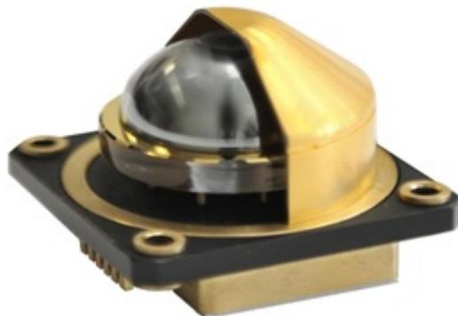
그림2 반구형 공진기 각속도계 hemispherical resonator gyroscope; HRG의 예. 각속도계가 회전하면 코리올리 힘에 의해 내부의 반구형상 석영 진동자의 공진 모드가 서서히 세차운동을 하게 되고 이를 측정하여 각속도를 알아낸다. 석영 진동자의 Q는 진공에서  $10^7 \sim 10^8$  수준으로 굉장히 높아 정밀한 측정을 가능케 한다.
