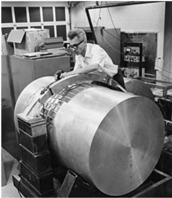
그림3 메릴랜드 대학교수 조셉 웨버(Joseph Weber)와 그의 중력파 검출 장치. 원통형 알루미늄 실린더에 고유진동수(1660 Hz)와 일치하는 주 파수의 중력파가 작용하면 생겨나는 공명 진동을 옆면의 압전 소자 등으로 측정한다. 그는 1967년부터 이 장치로 중력파를 검출하였다는 보고를 이어왔으나 다른 실험실에서의 교차 검증 결과 신빙성이 없는 것으로 결론지어졌다.<APS NEWS vol.29, Feb. 2020> 중력파의 직접 검출은 미국 LIGO에서 광간섭계 기반으로 2015년 성공하였다.
