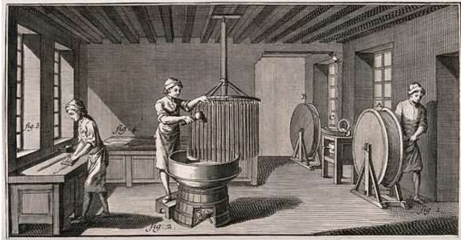
[그림 3] 지방 양초의 제조 공정을 보여주는 18세기 판화. (출처: wiki commons)
