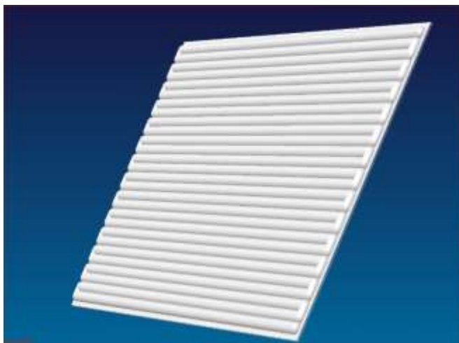
[그림 14] 필자가 개발에 참여했던 평판형 형광램프의 모식도.
