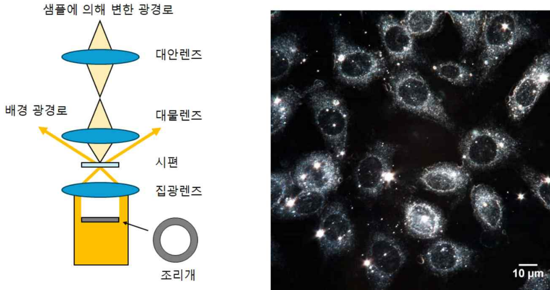
그림 . 암시야 현미경의 원리 및 측정 결과 [3]
