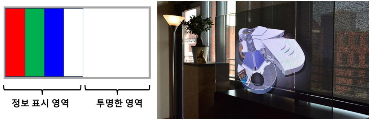
[그림 10] 투명 디스플레이의 화소 구조(왼쪽) 및 투명 디스플레이의 한 예(오른쪽). (출처: wiki commons).
